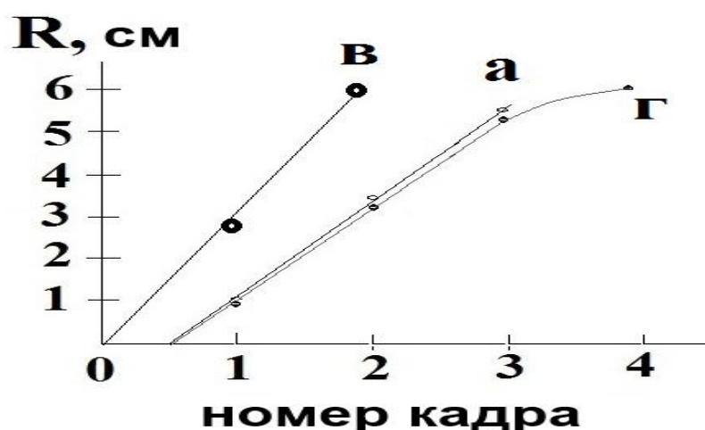
Рис. 1.9. Динамика увеличения радиуса R фронта ламинарного пламени, рассчитанная по увеличению видимого радиуса фронта пламени из данных Рис. 1.8: опыты а; в; г. P_0 = 1 атм, 600 кадров/с.
